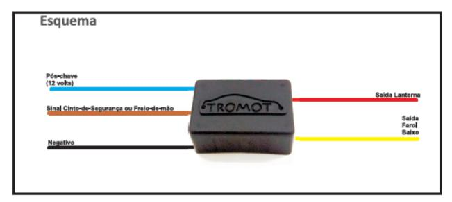
APLICAÇÃO: Veículos da linha Chery com acionamento POSITIVO de farol por relé ou por contatos da chave de farol.
