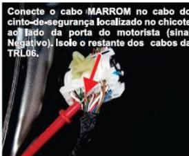
Retire o terminal 7 do conector e coloque os cabos CINZA e LARANJA/PRETO fazendo uma ponte. Conecte o cabo MARROM no cabo do cinto-de-segurança localizado no chicote ao lado da porta do motorista (sinal Negativo). Isole o restante dos cabos da TRL06.
