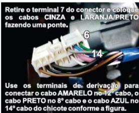
Use os terminais de derivação para conectar o cabo AMARELO no 12º cabo, o cabo PRETO no 8º cabo e o cabo AZUL no 14º cabo do chicote conforme a figura.
