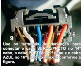
Use os terminais de derivação para conectar o cabo VERDE/PRETO no 14º cabo, o cabo PRETO no 9º cabo e o cabo AZUL no 16º cabo do chicote conforme a figura.
