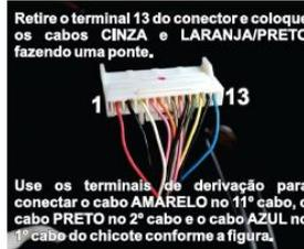
Use os terminais de derivação para conectar o cabo AMARELO no 11º cabo, o cabo PRETO no 2º cabo e o cabo AZUL no 1º cabo do chicote conforme a figura.
