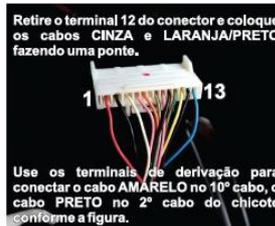
Use os terminais de derivação para conectar o cabo AMARELO no 10º cabo, o cabo PRETO no 2º cabo do chicote conforme a figura.
