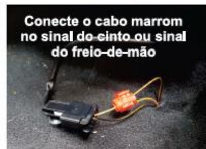
**Terceiro Passo:** Verifique toda a ligação e isole o terminal exposto com o termo-retratil e monte com cuidado o veículo novamente.
