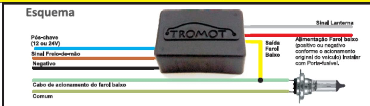
**APLICAÇÃO:** Veículos com acionamento de farol por relé ou por contatos da chave de farol. Para veículos com módulos de farol ou rede CAN, usar a TRL01.
